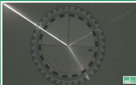
Abb 2: Experiment zum quantitativen Auswerten beim Übergang von optisch dünnen nach dichten Medien (zu b)
